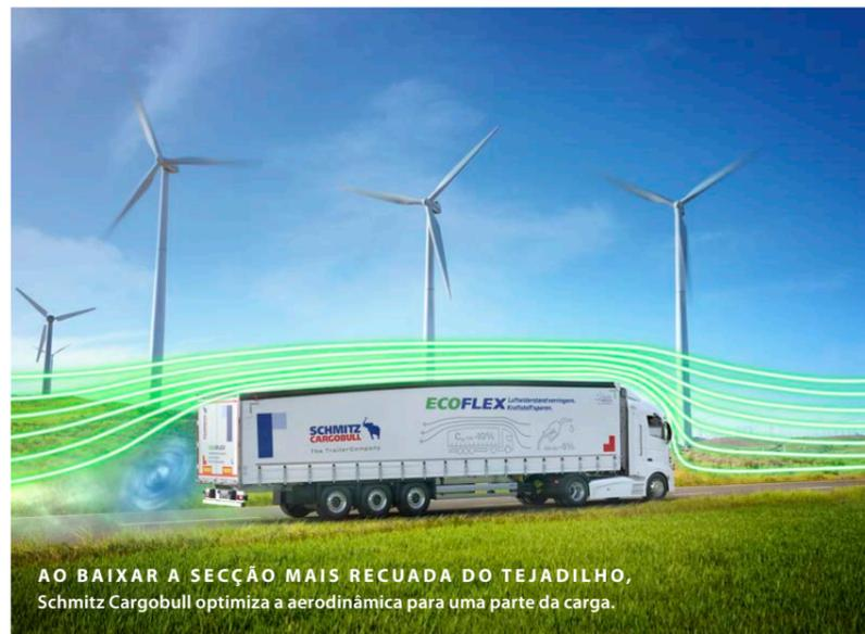
AO BAIXAR A SECÇÃO MAIS RECUADA DO TEJADILHO, Schmitz Cargobull otimiza a aerodinâmica para uma parte da carga.
