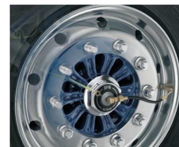
**SISTEMAS DE CONTROLO DA PRESSÃO DOS PNEUS E DE ENCHIMENTO** asseguram a pressão ideal dos pneus e evitam consumos adicionais desnecessários.
