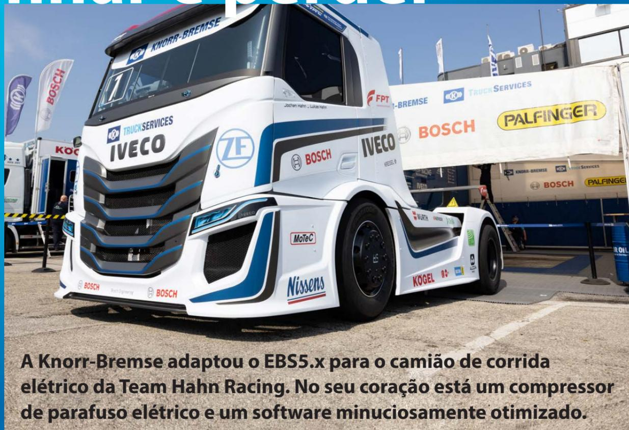
**A Knorr-Bremse adaptou o EBS5.x para o camião de corrida elétrico da Team Hahn Racing. No seu coração está um compressor de parafuso elétrico e um software minuciosamente otimizado.**
