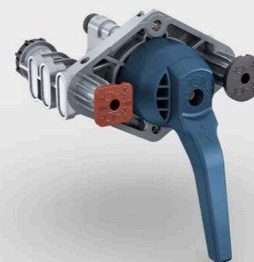
ZAWÓR MANEWROWY I POSTOJOWY oferuje znaną obsługę za pomocą dwóch przycisków, a także zintegrowaną funkcję podnoszenia i opuszczania.
