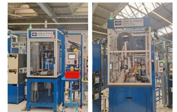
En las pruebas finales de calidad, se comprueba la estanqueidad del muelle de energía de la NG3 EVO y de todas las piezas delanteras y traseras del actuador.
