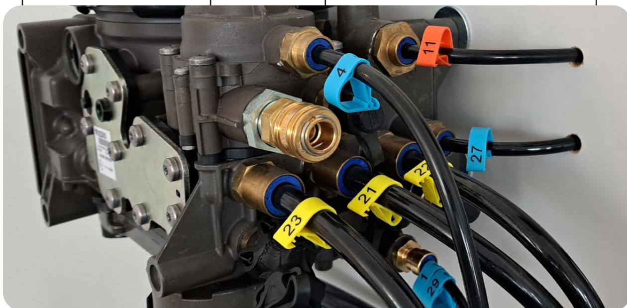
Los marcadores de tubería identifican claramente cada línea.
