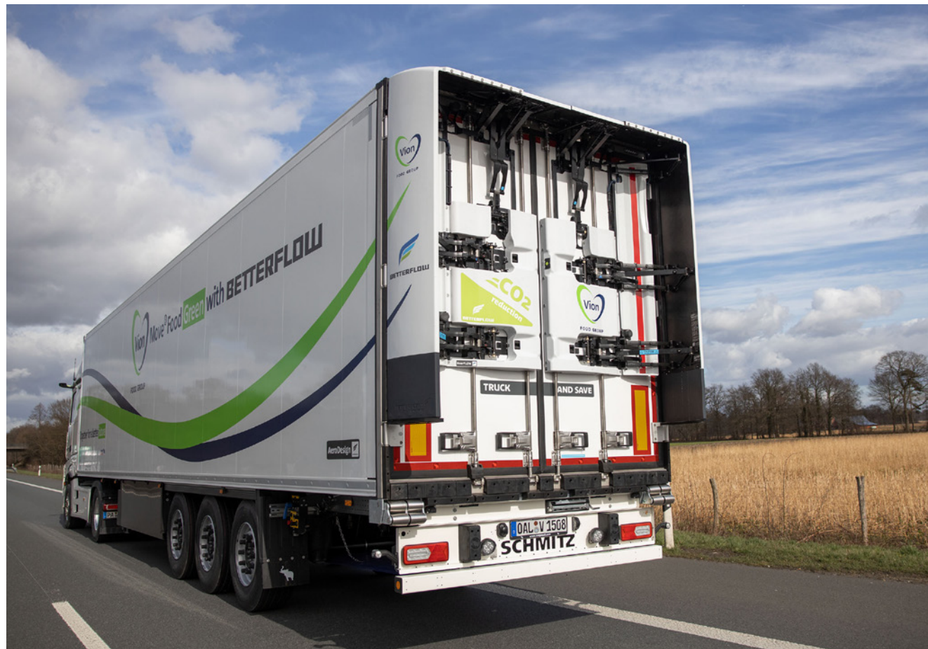
DAS HECKFLÜGELSYSTEM AM VION-LKW öffnet sich bei 60 Kilometern pro Stunde automatisch.
