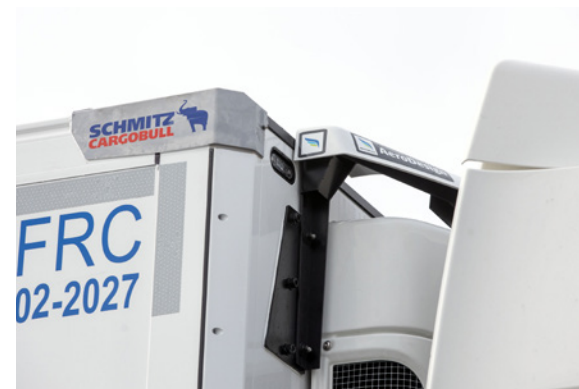
DAS VORFLÜGELSYSTEM macht den Dachübergang zwischen Zugmaschine und Trailer weniger anfällig für Luftwirbel.
