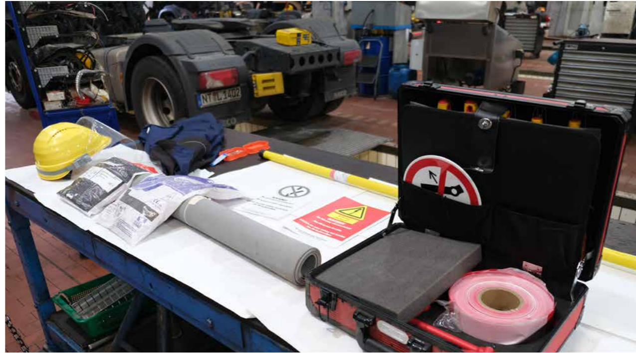
ZUR AUSRÜSTUNG gehören auch ein Schutzhelm mit Visier, Isoliermatte, spezielle Handschuhe und einiges mehr.
