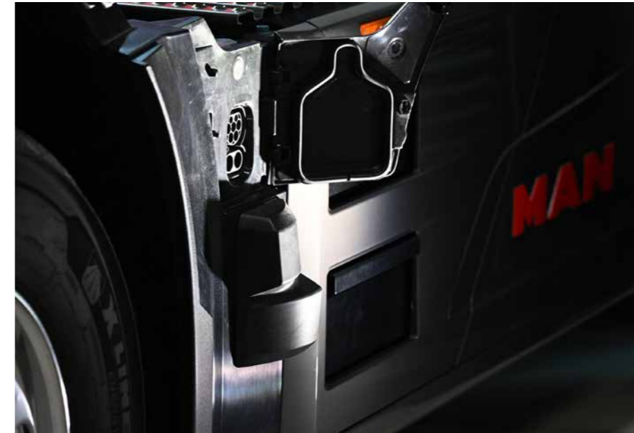
CCS- (OBEN) UND MCS-DOSE (LINKS) IM VERGLEICH. MCS erlaubt künftig das Laden mit bis zu 3,75 Megawatt, während CCS auf unter 500 kW limitiert ist.
