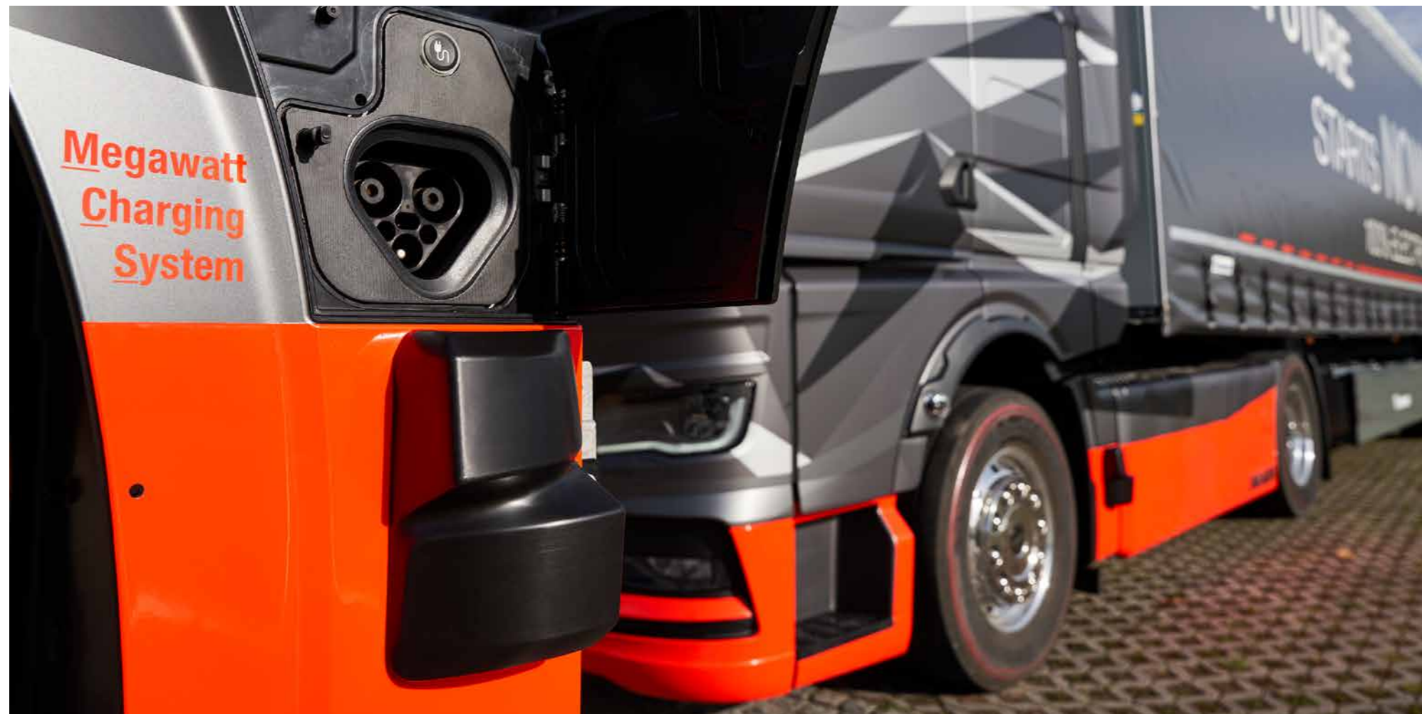
CCS- (OBEN) UND MCS-DOSE (LINKS) IM VERGLEICH. MCS erlaubt künftig das Laden mit bis zu 3,75 Megawatt, während CCS auf unter 500 kW limitiert ist.
